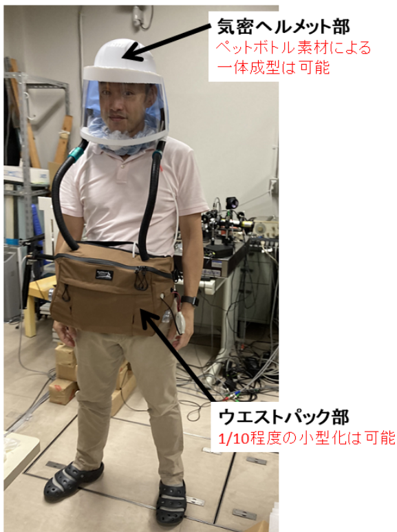
図1. 「自由外出マスク」の試作2号機 (→専用部品的设计・製作により大幅な小型軽量化は可能)
