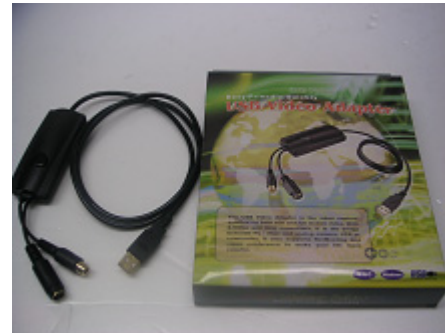
アルファデータ製 USB 2.0 ビデオキャプチャアダプタ AD-VD0US2 (2台での同時運転の確認済み)
