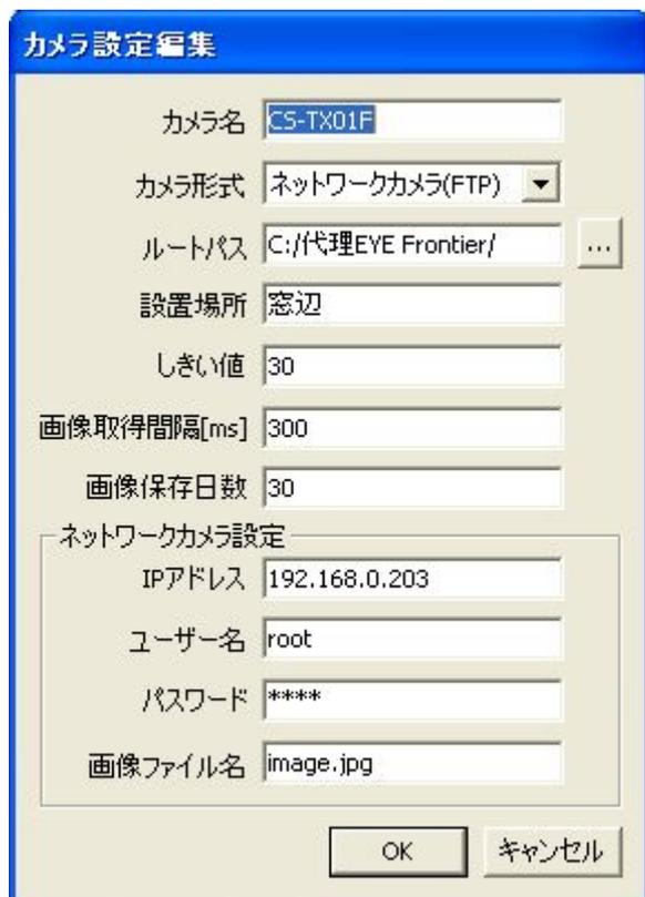
カメラ選択ダイアログで「編集」ボタンもしくは「新規作成」ボタンをクリックすると、上図のようなカメラ設定編集ダイアログが現れます。ここでカメラの設定を編集します。
