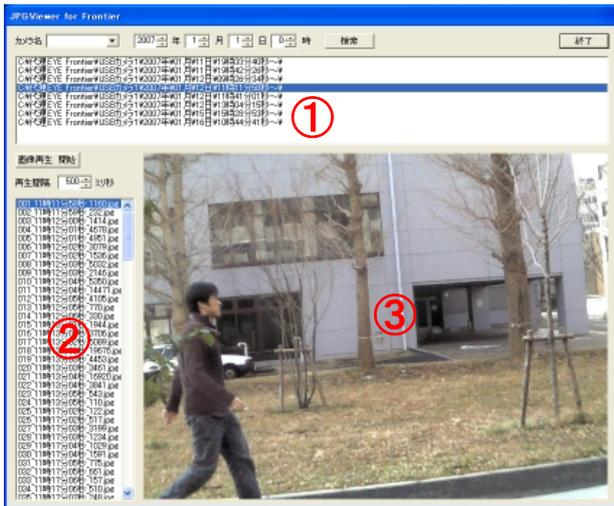
JPGViewer for Frontier を起動すると、①に撮影された画像が保存されているフォルダの一覧が表示されます。フォルダの一覧からフォルダを選択すると、②に選択されたフォルダ内の画像一覧が表示されます。画像の一覧から見たい時間の画像を選択すると、③に選択された画像が表示されます。
